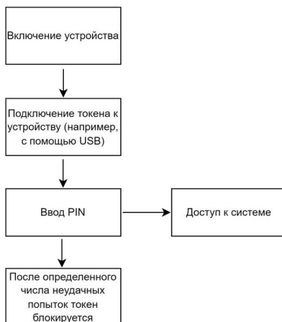
Рис. 3. Схема работы с токеном
