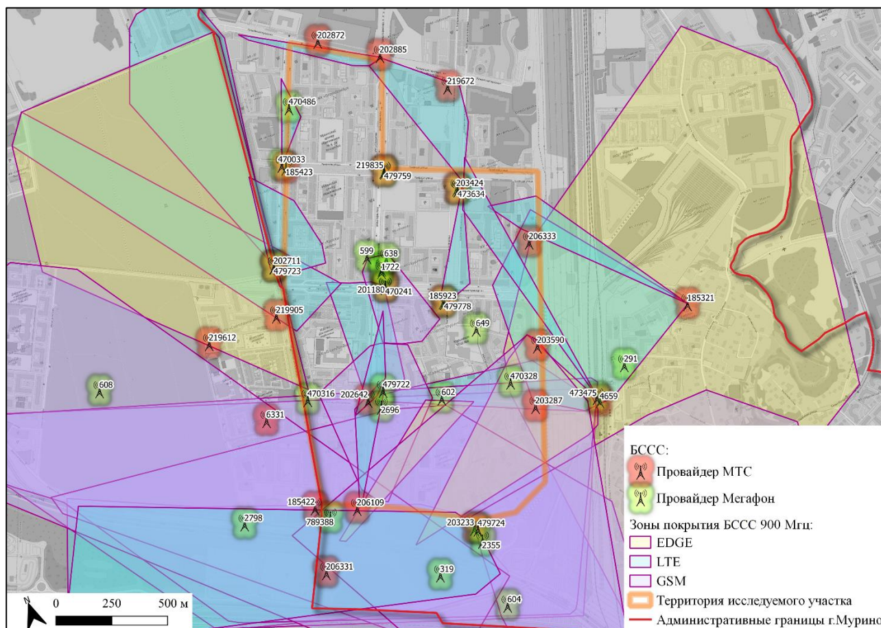
Рис. 1. Зоны секторов БССС на частоте 900 МГц
