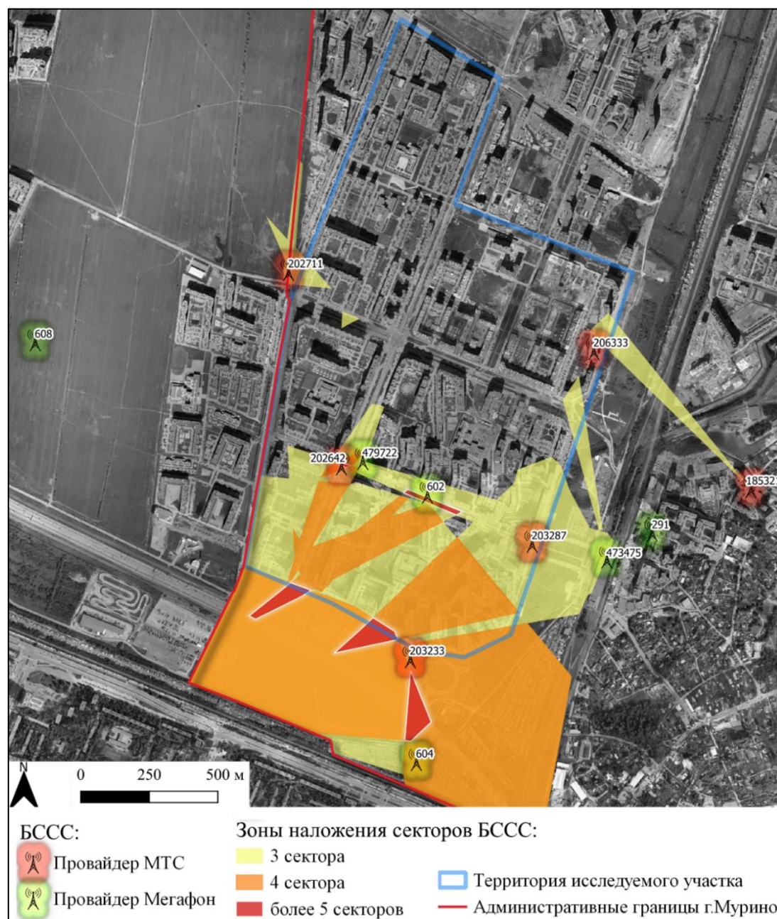
Рис. 2. Зоны наложения секторов БССС на частоте 900 МГц
