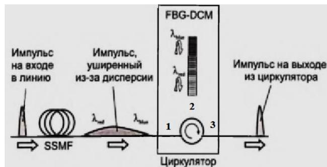
Рис. 2. Схема включения FBG-DCM
