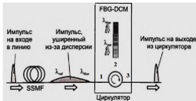
Рис. 2. Схема включения FBG-DCM
