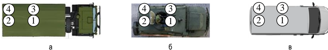
Рис. 5. Варианты размещения антенны на кузове «КАМАЗа» (а), «Тигра» (б) и «Газели» (в)
