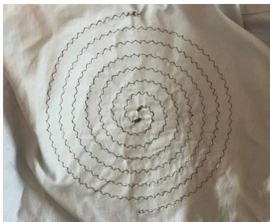
Рис. 4. Образец № 2 с нанесением антенны при помощи токопроводящей нити
