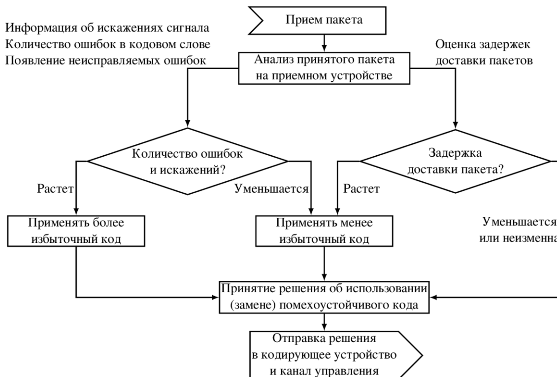
Рис. 2. Алгоритм принятия решения о выборе помехоустойчивого кода для адаптивной системы передачи
