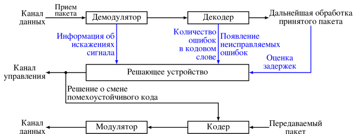
Рис. 1. Блок-схема приемопередатчика системы с адаптивным помехоустойчивым кодированием
