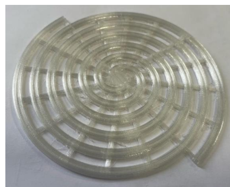
Рис. 9. Корпус спиральной антенны из гибкого пластика
